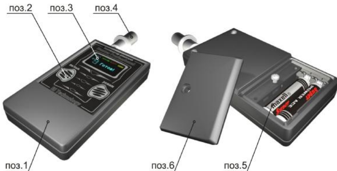
Рисунок 2 – расположение основных частей изделия
